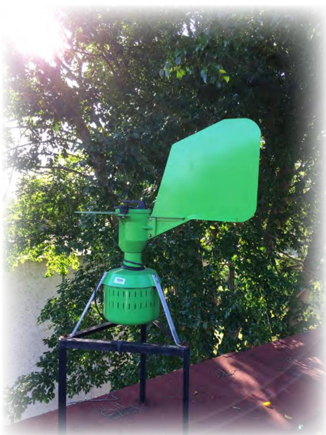
**Figura 1.** Trampa de esporas tipo Burkard (muestra de equipo de la DACBiol-UJAT).
