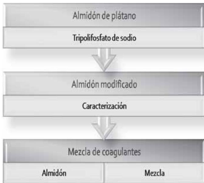
**Figura 3.** Metodología para la obtención de almidón modificado de plátano uso de la mezcla de coagulantes.
