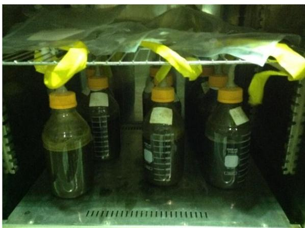
**Figura 2.** Unidades experimentales dentro de la estufa para mantener temperatura constante.
