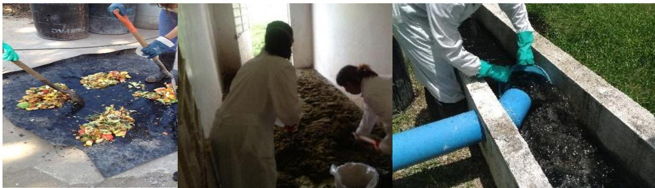
**Figura 1.** A) Método de cuarteo para la FORSU. B) Obtención del CGRV en un rastros municipal. C) Obtención de los lodos en una PTAR.
