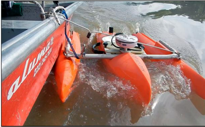
Figura 4. Equipo Doppler RiverRay.
