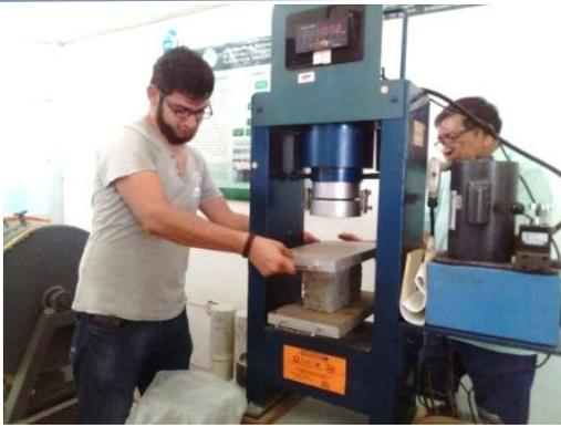
**Figura 1.** Pruebas de compresión a la resistencia.
