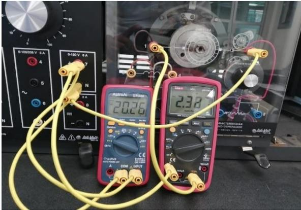
**Figura 3.** Circuito para calcular resistencia de armadura.
