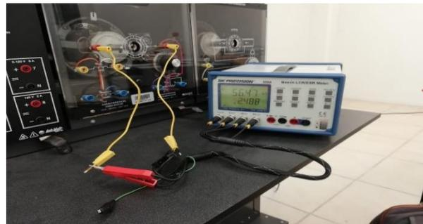
**Figura 5.** Circuito de armadura con LCR Meter.
