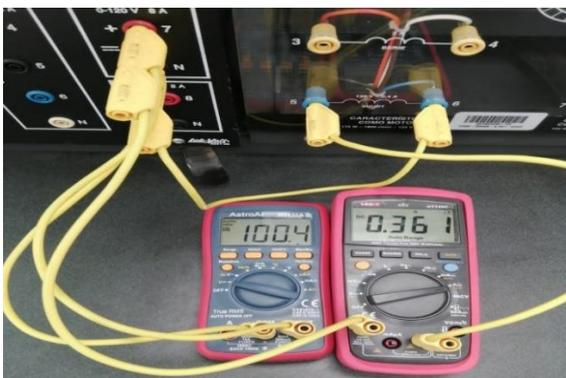
**Figura 4.** Circuito para calcular resistencia de campo.
