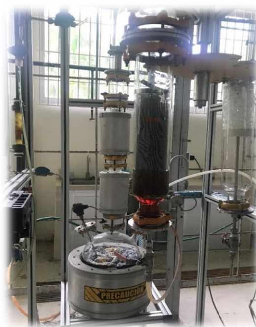
Figura 1. Equipo de extracción del aceite de café.
