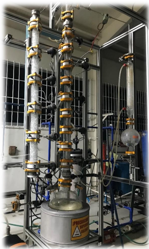
Figura 2. Equipo de destilación del alcohol.
