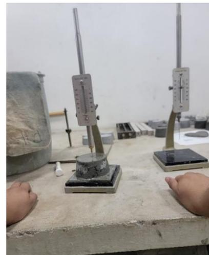
**Figura 2.** Medición del tiempo de fraguado con el aparato de Vicat.
