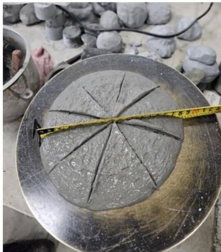
**Figura 1.** Fluidez de 180 mm  $\pm$  5 mm de la pasta de cemento añadiendo azúcar.
