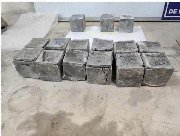
**Figura 7.** Daño en muestras elaboradas con azúcar.
