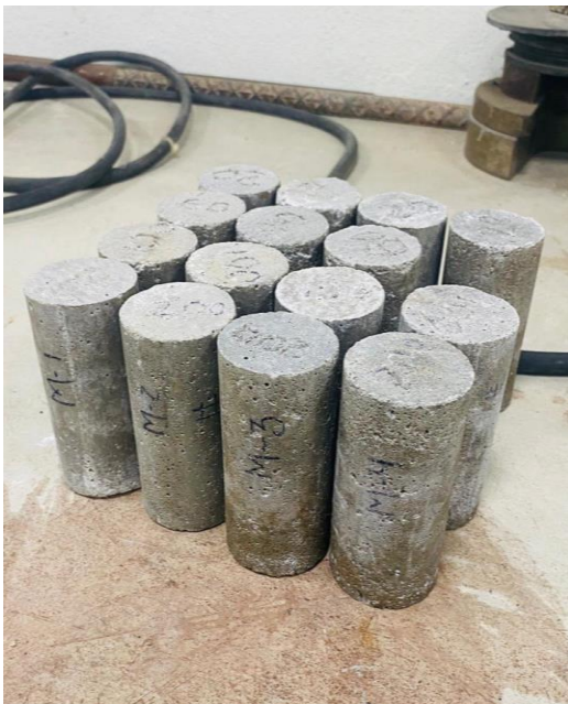
Figura 1. Probetas cilíndricas preparadas con triturado de concha de ostión.
