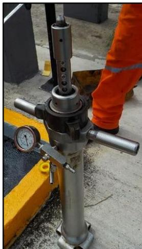
**Figura 8.** Equipo "retriver" para retiro/inserción de cupones corrosimétricos
