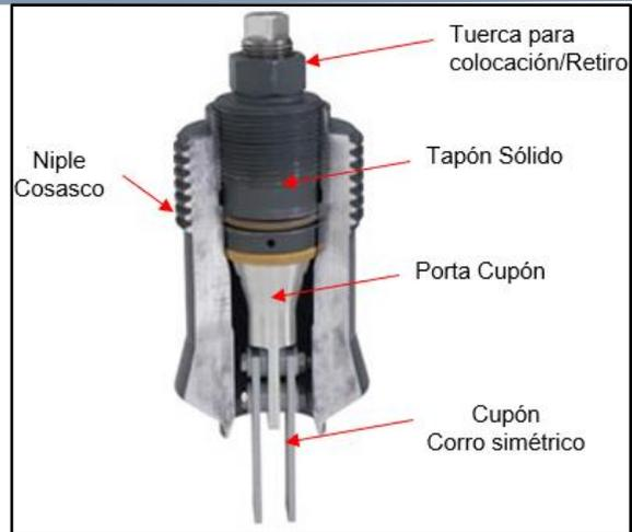
Figura 3 Arreglo de Niple Cosasco® Original.
