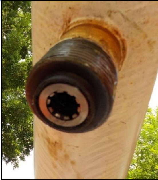
**Figura 27.** Tapón Sólido Rediseñado en Operación. Se puede apreciar que ya no cuenta con la tuerca externa.
