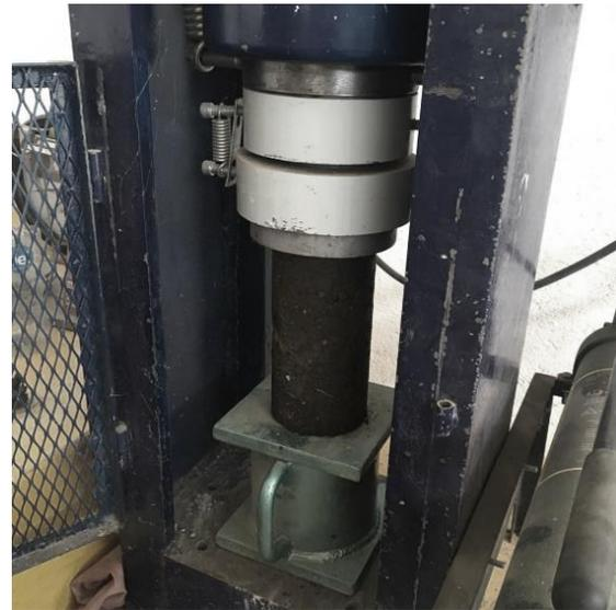
**Figura 6.-** Especimen en prensa Hidráulica para ensayo a compresión simple.
