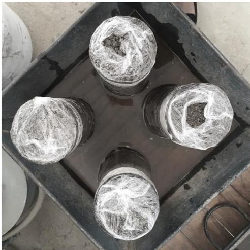
**Figura 5.** Sumergimiento de especímenes para prueba de absorción capilar.
