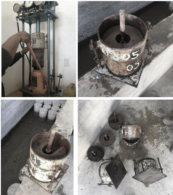
**Figura 7.-** Preparación, acondicionamiento de especímenes y ejecución de prueba de valor relativo de soporte.
