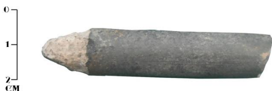
Figura 3. Ejemplo de electrodo negativo con terminación cóncava por el desgaste.
