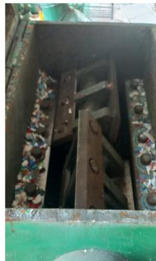
**Figura 3.** PEAD triturado dentro de la trituradora
