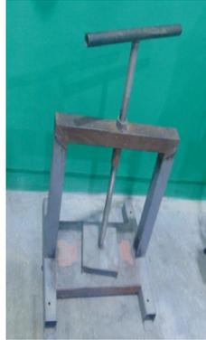
**Figura 7.** Prensa manual tipo tornillo
