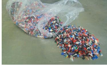
**Figura 4.** PEAD triturado y secado
