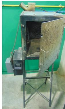
**Figura 6.** Horno para fundición del plástico
