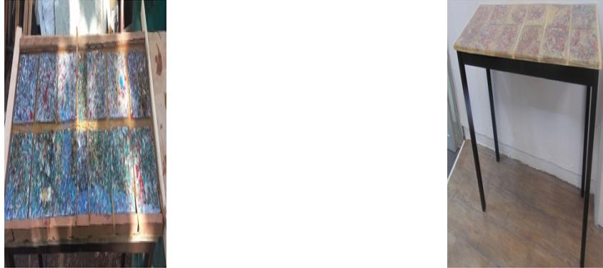
**Figura 11.** Tablas unidas con resina epóxica en molde mientras se solidifican y mesa binaria
