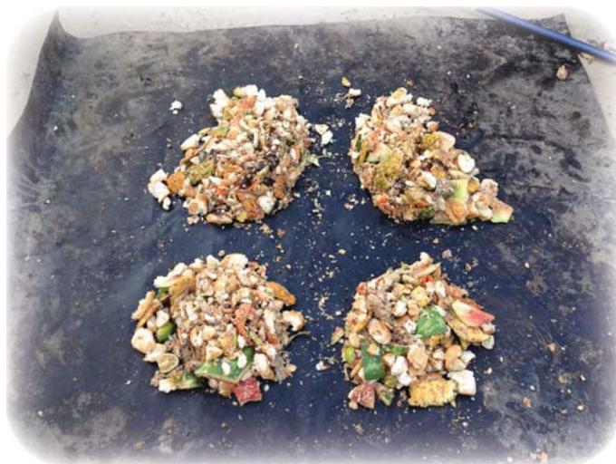
Fotografía 1. Obtención de la muestra por método de cuarteo.
