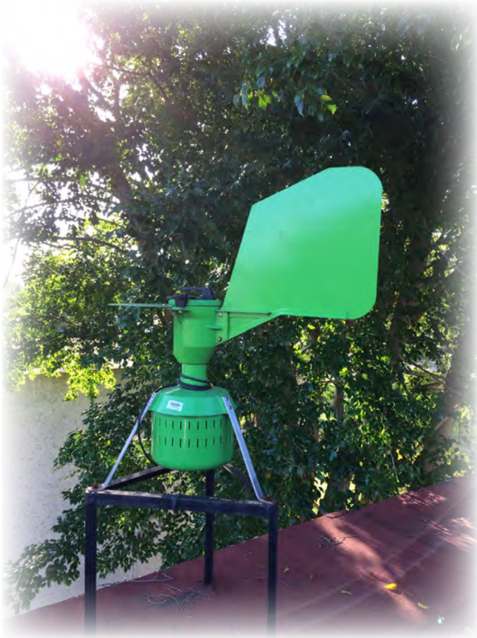
Fotografía 1. Trampa de esporas tipo Burkard (muestra de equipo de la DACBIol-UJAT).
