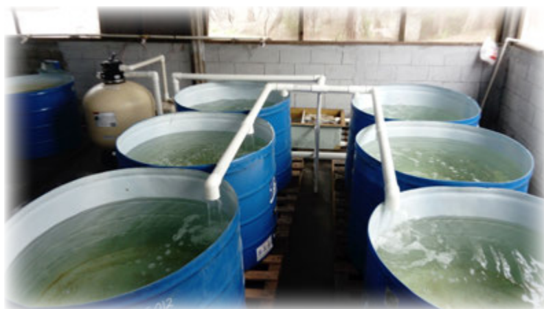
Figura 2. Sistema de recirculación de agua.
